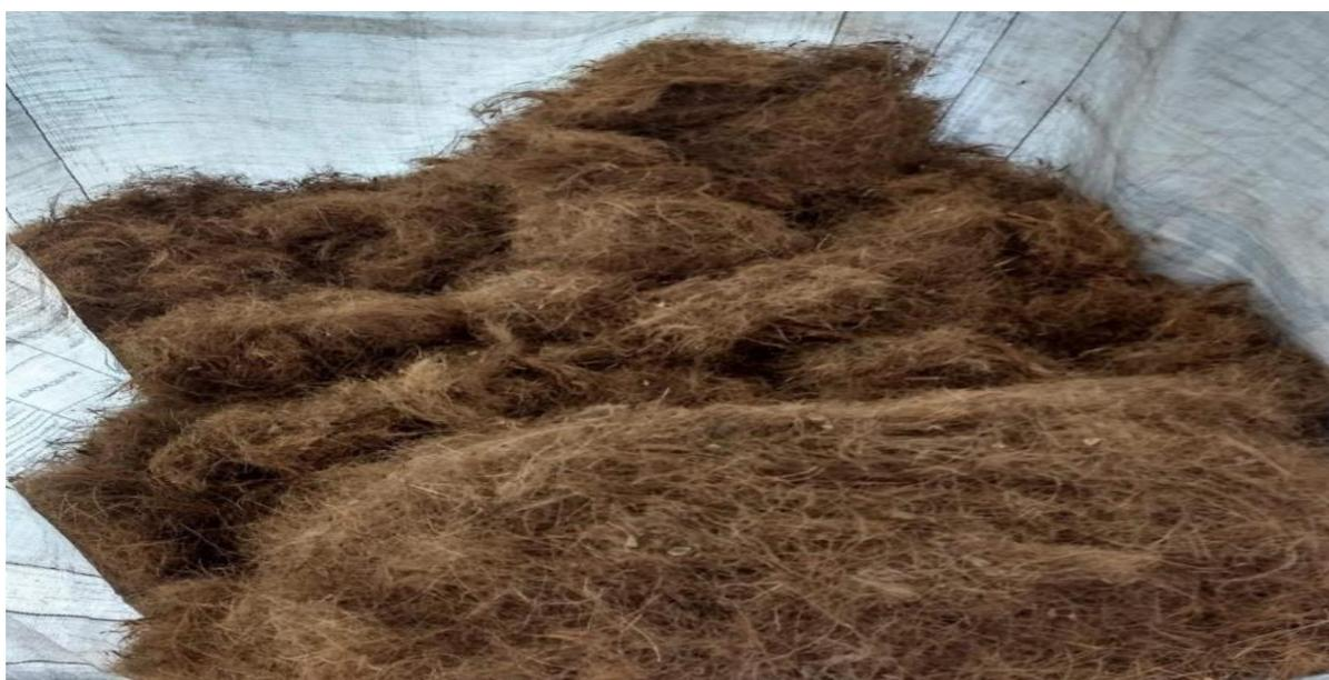
**Figura 5: Separação das fibras da casca do coco verde**
