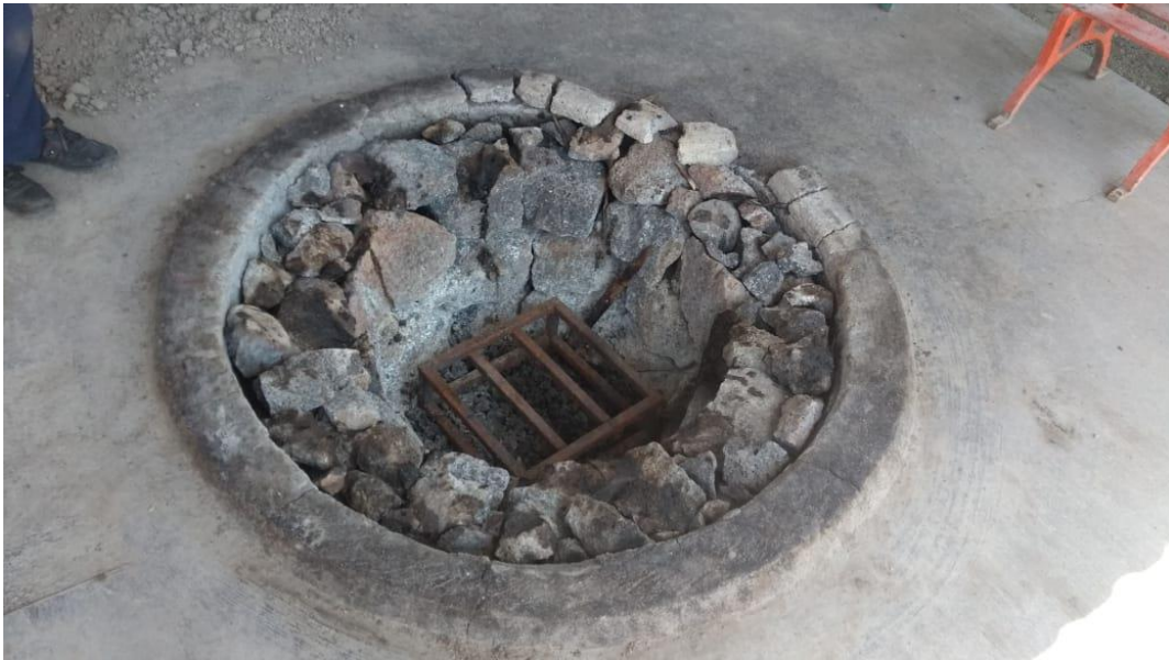
Ilustración 1: Horno tradicional de ladrillo y piedra para elaboración de barbacoa . Medio de calefacción: leña
